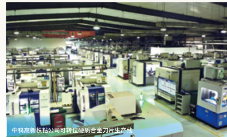
中钨高新株钻公司可转位硬质合金刀片生产线
